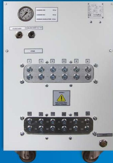
Autarke Sequenzsteuerung für die gestaffelte Ansteuerung von Verschlussdüsen in Heißkanalwerkzeugen für Spritzgießmaschinen. Wir bieten Sequenzsteuergeräte mit hydraulischem Antrieb. Kaskadesteuergeräte mit hydraulischem Antrieb beinhalten eine Steuerung, Pumpengruppe, Druckakkumulator, Behälter, Verteilerblock mit Elektroventilen, Regelungssystem, Kontroll-Mess-Anlage und Ölkühlgruppe.
